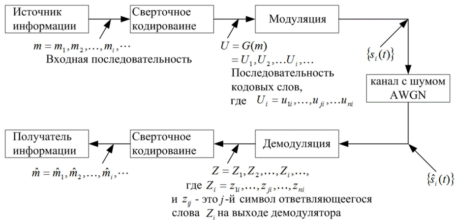
Рисунок 1. Упрощенная схема цифровой системы связи
