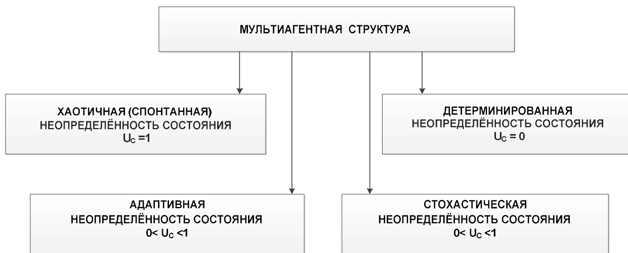
Рис. 1 – Классификация мультиагентных распределенных структур в зависимости от значения неопределенности состояния
