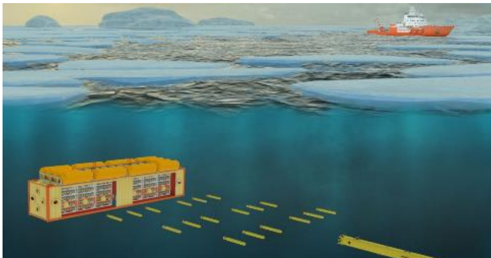
Рис. 1 – Сейсморазведка с использованием группы АНПА
