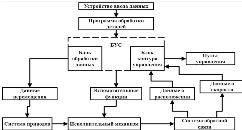
Рис.1. Схема работы фрезерного станка с ЧПУ
