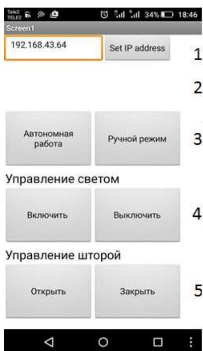
Рис. 7. – Интерфейс системы автоматического управления освещением
