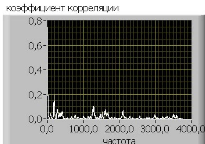
Рисунок 3 – Коэффициент взаимной корреляции спектра ключевой фразы речевого сигнала с весовой обработкой при ширине скользящего окна: в 1/16 ширины полосы частотного анализа
