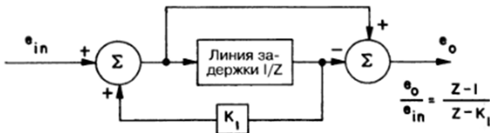
Рис. 1. –Доплеровский фильтр 1-го порядка
