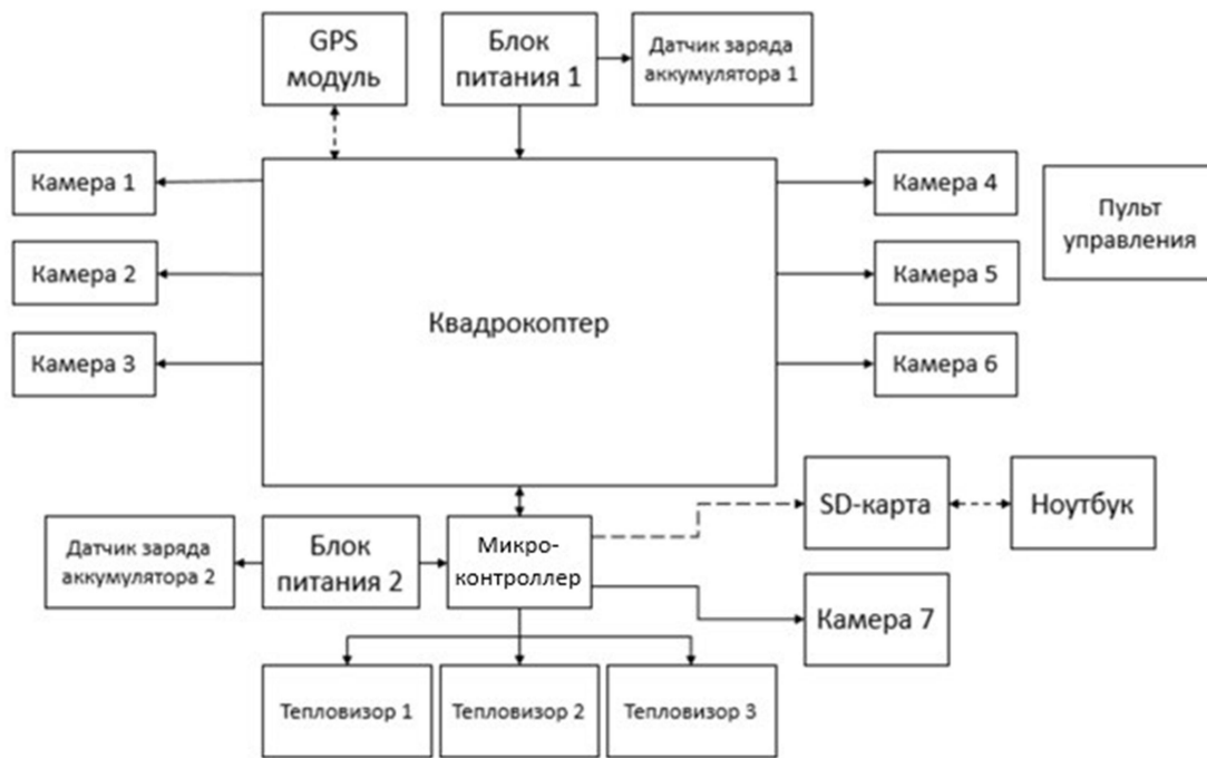
Рис. 2 – Структурная схема БЛА тепловизионного обследования объектов
